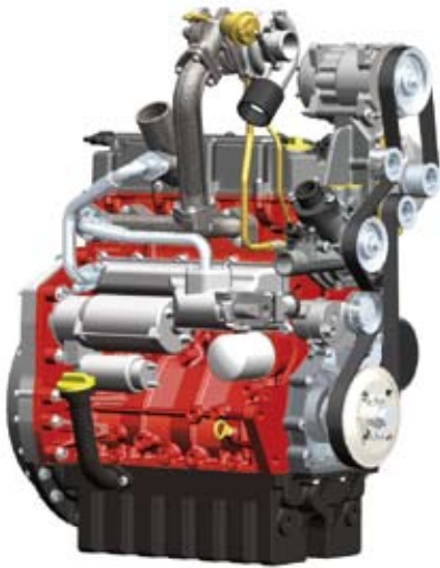
20XX Tier 4 interim (28–55,9 kW). Flüssigkeitsgekühlter Motor: 4-Zylinder-Saug- und Turbomotoren in Reihenbauweise mit oder ohne Ladeluftkühler. Hubvolumen 2,9 Liter pro Zylinder. Common Rail-Hochdruckeinspritzsystem, extern gekühlte Abgasrückführung (ecAGR).
